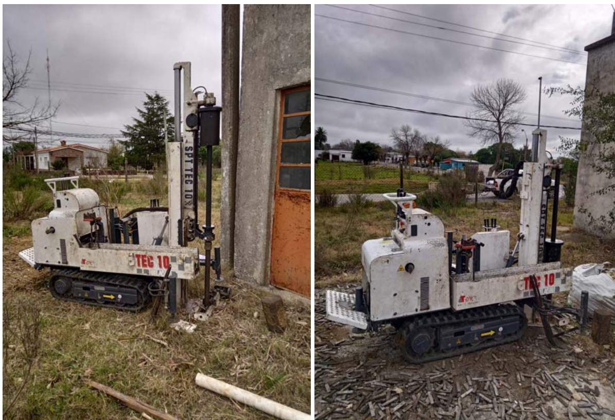
Figura 3. Equipo de perforación y ejecución de ensayos SPT utilizado en el Estudio
